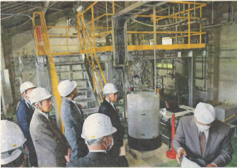
廃アルミから「アルミ水素」を抽出する水素製造装置 ＝モンラック・タカオカ
