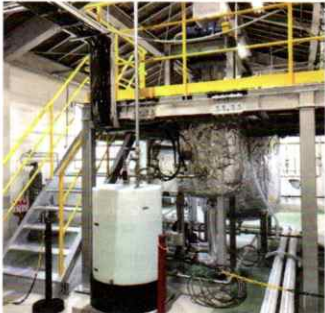
温泉パッケージの水素貯蔵槽。アルミから生成した水素を貯蔵する
